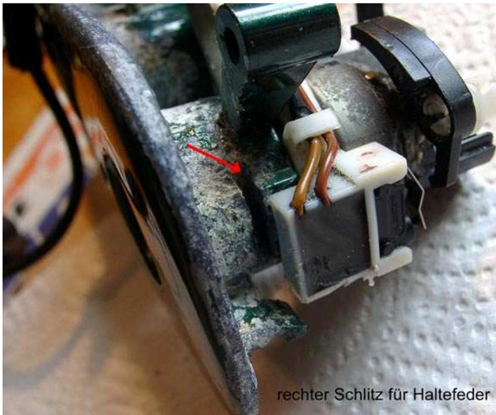
Nachdem die Haltefeder entfernt ist, kann jetzt der Schließzylinder samt Gestänge in der Regel nach innen vom Griff abgezogen werden. Falls das nicht möglich ist (wie bei mir), kann man ihn mit Hilfe einer **passenden** Stecknuß (z.B. 1/4 Zoll), vorsichtig nach innen rausklopfen. Ich habe dazu die Rückseite eines Schraubendrehers genommen. Ein leichter Hammer sollte auch funktionieren.
