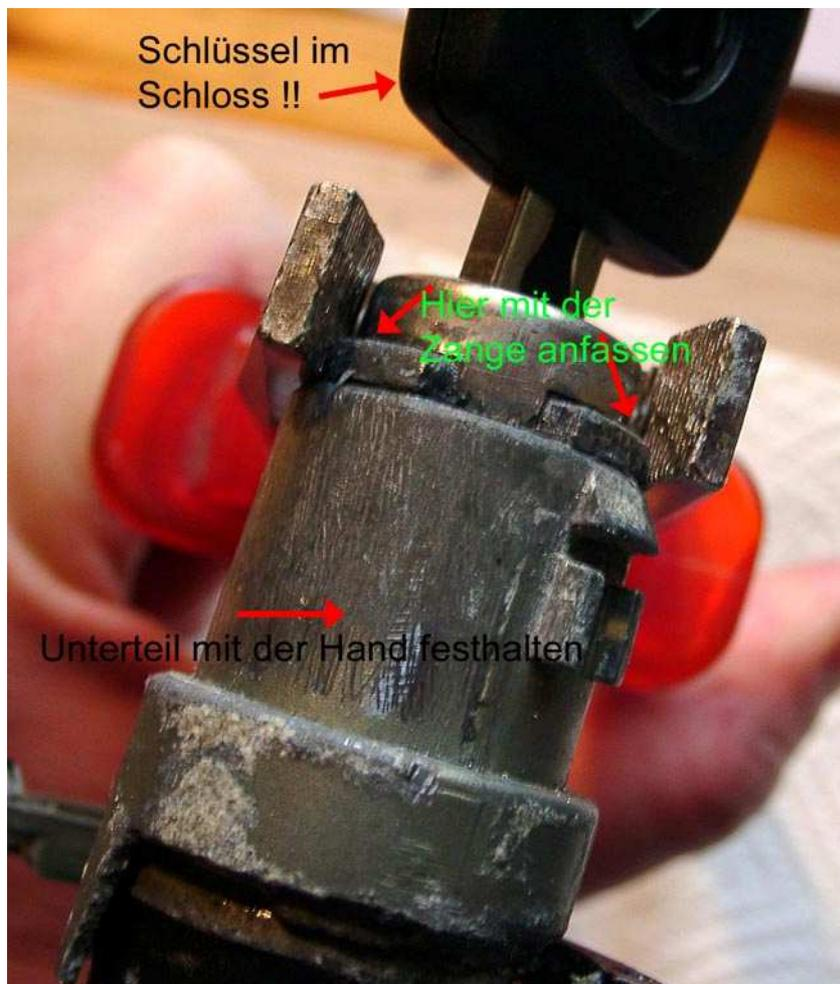
Mit der Zange kann man an den beiden roten Pfeilen das Schloss im Schließzylinder drehen.
